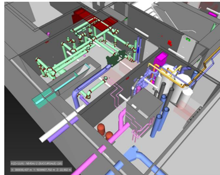
Extrait maquette mécanique de construction
